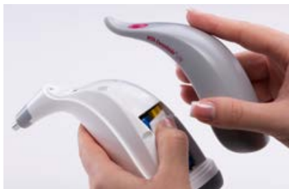
Figura 6 – Sostituzione della batteria: rimettere il coperchio
