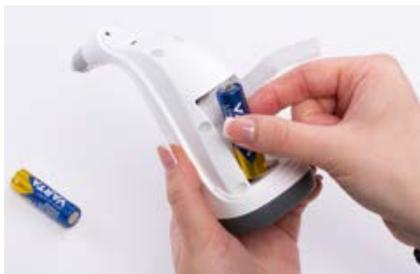
Figura 4 – Sostituzione della batteria: rimuovere la batteria sinistra
