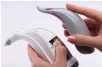
Figura 6 – Sostituzione della batteria: rimettere il coperchio
