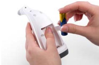
Figura 5 – Sostituzione della batteria: inserire la batteria nuova
