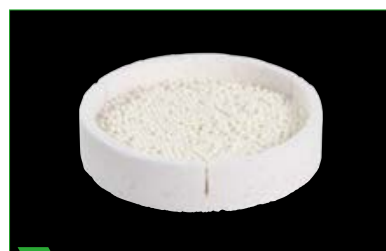
3 Encher a bandeja de sinterização MS com pérolas de sinterização (um leito de pérolas de pelo menos 3 camadas).
