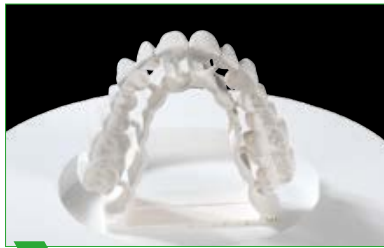
5 Restauração separada e retrabalhada com estabilizador de sinterização.
