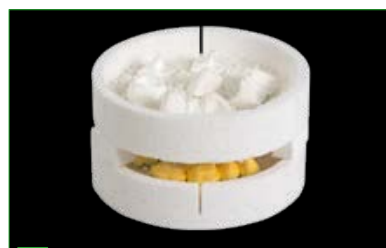
9 Sinterização simultânea de restaurações Color/Multicolor pré-coloridas e coloridas manualmente.
