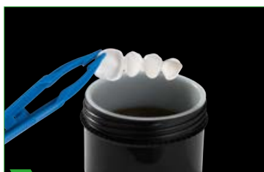
2 Mergulhar a estrutura com uma pinça livre de metal no líquido de coloração...
