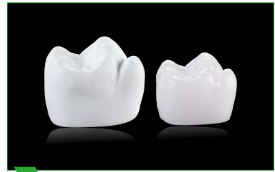
3 Molar antes e após a sinterização; Encolhimento de sinterização de aprox. 20 por cento
