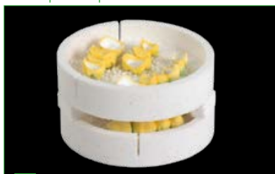
7 Empilhamento da bandeja de sinterização MS para restaurações coloridas manualmente.
