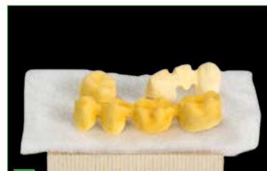
6 Secar as restaurações impreterivelmente antes de sinterizar.
