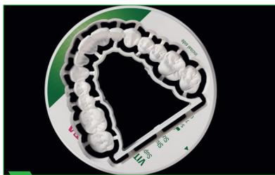
1 Brücke mit skelettiertem Sintersupport nach dem Fräsprozess.
