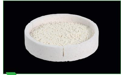
3 Sinterschale MS mit Sinterperlen (mind. 3-lagiges Perlenbett) füllen.
