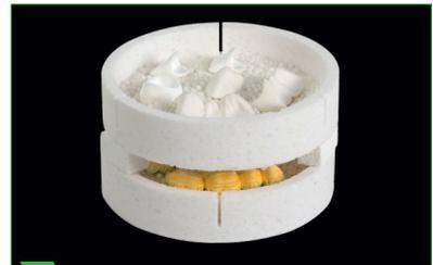
9 Gleichzeitiges Sintern von vorgefärbten Color/Multicolor- und manuell eingefärbten Restaurationen.
