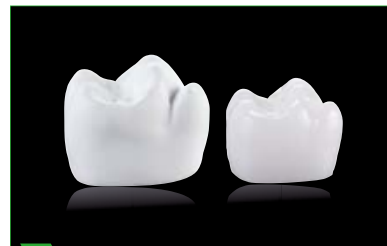
3 Molar antes y después de la sinterización; contracción de sinterización del 20 por ciento, aprox.
