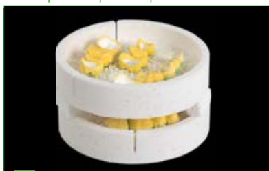
7 Apilado de la bandeja de sinterización MS con restauraciones coloreadas manualmente.
