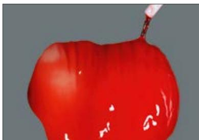
VITA ADIVA CERA-ETCH наносится маленькой одноразовой кисточкой на протравливаемую поверхность. Длительность протравки: 40 сек. После этого нужно удалить все кислотные остатки на протравленной поверхности при помощи промывания чистой водой, интенсивной очистки паром или в ультразвуковой ванне в дистиллированной воде. Нельзя использовать щетку, так как возникает риск загрязнения поверхности!
