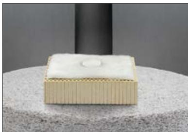
Bei der Verwendung von Brennwatte kann die Temperatur je nach Ofen um 10-20 °C, teilweise sogar bis 40 °C vom angegebenen Richtwert abweichen und muss dem entsprechend angehoben werden.
