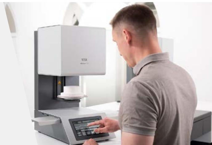
Der Keramikbrennofen überzeugt mit einem 7-Zoll-Touchdisplay mit hoher Reaktionsgeschwindigkeit und selbsterklärender Bedienoberfläche. Dadurch macht es nicht nur Spaß mit dem Ofen zu arbeiten, sondern man spart auch wertvolle Zeit.
