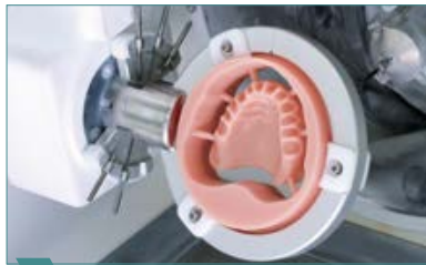
2 Die definitive OK-Prothesenbasis fräsen.
