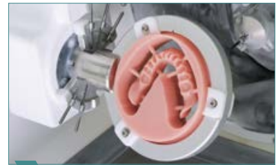
3 Die definitive UK-Prothesenbasis fräsen.
