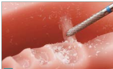
4 Die Prothesenbasen aus der Disc heraustrennen. Anstiftstellen bündig verschleifen.
