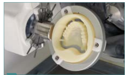
3 Die Wachs-Disc für die vollformatige Wachseinprobe (OK) fräsen.
