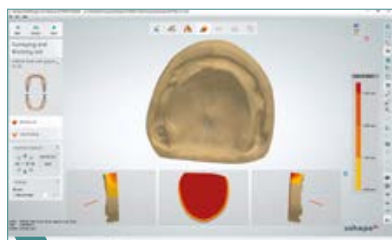
7 Die Einschubrichtung definieren. Hinterschnitte beachten.
