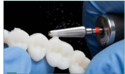
6 Anstiftstellen mit kreuzverzahntem HM-Fräser verschleifen.
