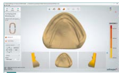
9 Die Einschubrichtung definieren. Hinterschnitte beachten.
