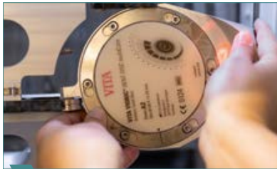
4 Die VITA VIONIC DENT DISC multiColor in den Halter der Fräsmaschine einspannen. Zahnkranz / Zahnelemente fräsen.
