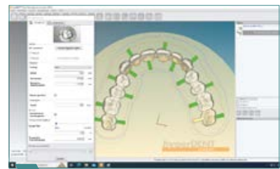
3 Genügend Konnektoren setzen, um die Restauration wenig Vibrationen beim Fräsvorgang auszusetzen.
