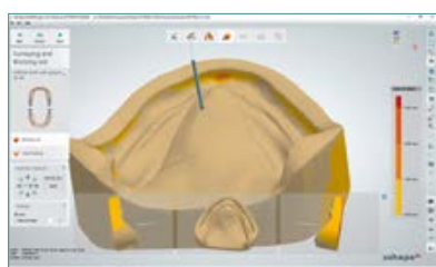
10 Hinterschnitte des Unterkiefers ausblocken.
