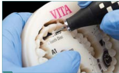
5 Zahnkranz/ Zahnelement mit kreuzverzahnten HM-Fräsern aus Disc heraustrennen.
