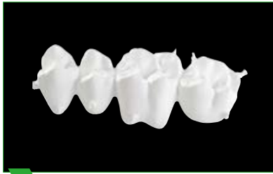
1 Φρεζαρισμένη αποκατάσταση αμέσως μετά τη διαδικασία CAM.
