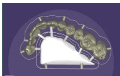
1 Γλωττίδες και κόμβοι πυροσυσσωμάτωσης
