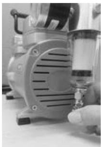
4. Collegare correttamente la pompa all'unità di cottura VITA.
