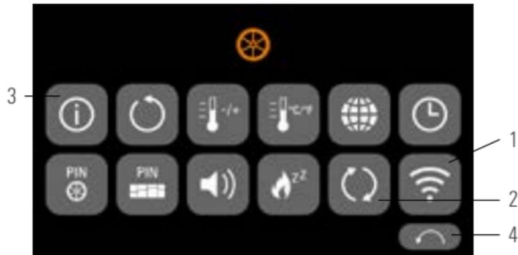
Figura 3 - Visão geral das definições do aparelho
