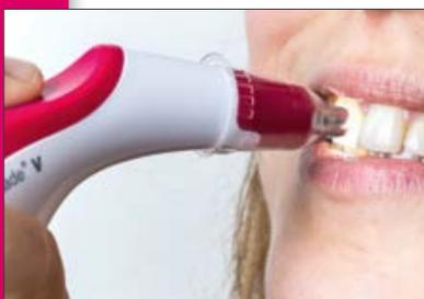
**CZ** – Pro změření středu dentinu stiskněte tlačítko měření.
