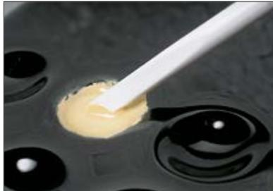
**⚠ Hinweis:** Die Flasche des lichtempfindlichen Liquids nach Entnahme sofort wieder verschließen. OPAQUE LIQUID ist ausschließlich für die Verwendung mit OPAQUE Pulver geeignet und darf nicht zusammen mit OPAQUE PASTE verwendet werden.
