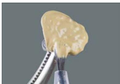
Наносится столько тонких слоев пастоопакера (мин. 2), пока металл полностью не будет закрыт. Благодаря пластичности материала OPAQUE PASTE он сохраняет стабильность на краях и ретенциях.
