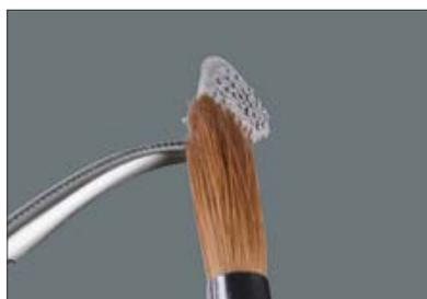
После пескоструйной обработки металлический каркас очищается. Очистка производится только компрессионным воздухом (с водоотделителем) или чистой кистью.
