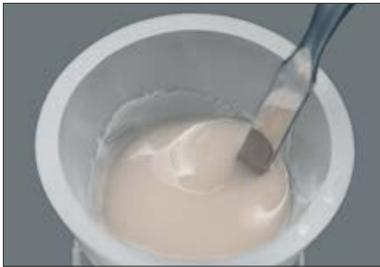
Nach gleichmäßigem Anrühren ist die Masse teigig und kann nach angemessener Quellzeit (ca. 1 Minute) verarbeitet werden. Die Verarbeitungsbreite beträgt ca. 4 – 5 Minuten, in Abhängigkeit von der Raumtemperatur.
