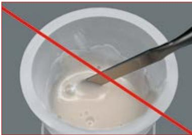
Schlieren und Blasen werden durch Einhalten des korrekten Anmischverhältnisses und durch gleichmäßiges Rühren mit dem Instrument am Boden des Anmischgefäßes vermieden.
