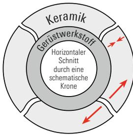
Ist der WAK des Gerüstwerkstoffes **sehr viel niedriger** als der WAK der Verblendkeramik, so erhöhen sich die tangentialen Zugspannungen und erzeugen radial nach außen verlaufende Risse. Dies kann zu Spätsprüngen führen.
