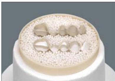
Mit COLORING LIQUID eingefärbte Restaurationen ausschließlich mit geschlitztem Tiegel sintern. Somit wird ein ungehindertes Ausbrennen der organischen Bestandteile gewährleistet.
