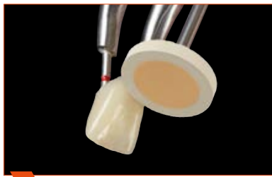
2 Polissage 1. avec la roue de pré-polissage et 2. avec la roue de polissage fin haute brillance.
