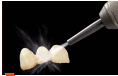
5 Sabler la restauration à l'Al 2 O 3 avec une pression max. de 2 bars.
