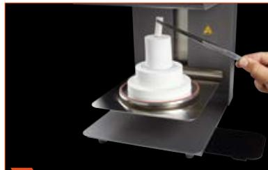
**6** Coloque o êmbolo de prensagem descartável sobre a pastilha com o ponto apontando para cima.
