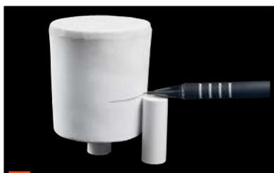
**1** Use o segundo êmbolo de prensagem para determinar a profundidade de prensagem por meio da marcação.
