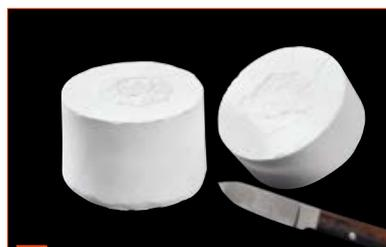
**3** Divida cuidadosamente a mufla com uma faca no ponto de ruptura predeterminado.
