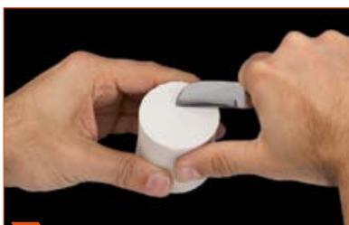
**2** Quebre as bordas da mufla sem que o material de revestimento caia no canal.
