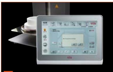
**2** Depois de abrir o forno, aparece a mensagem "Inserir material de prensagem".
