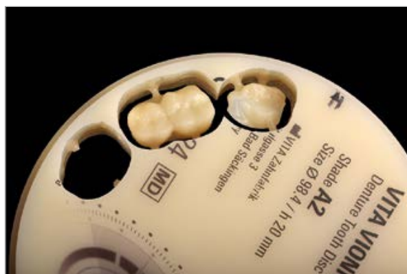
El material dental confeccionado mediante CAD/CAM en el VITA VIONIC DENT DISC multiColor.
