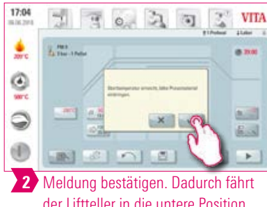
2 Ist das Pressmaterial eingelegt, Meldung bestätigen. Liffeller fährt in die Brennkammer. Programm startet.
