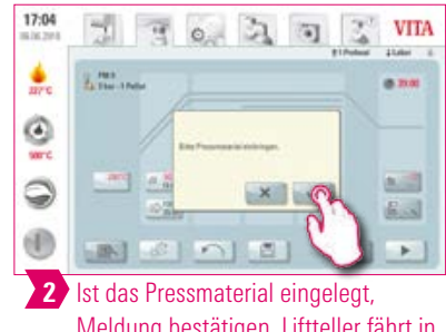
2 Meldung bestätigen. Dadurch fährt der Liffeller in die untere Position.
