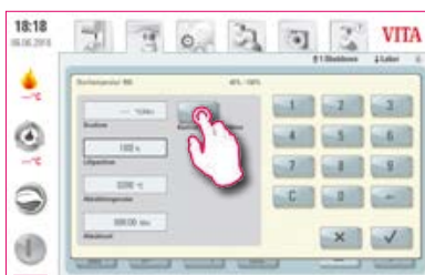
8 3a. fase de resfriamento: selecionar "Resfriamento controlado".
