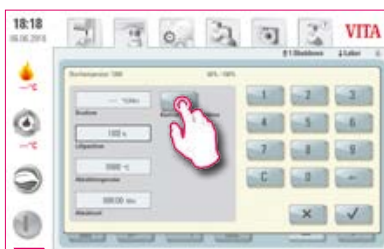
5 2a. fase de resfriamento: selecionar "Resfriamento controlado".
