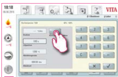
2 1a. fase de resfriamento: selecionar "Resfriamento controlado".
