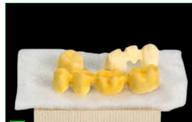
6 Essiccare tassativamente i restauri prima della sinterizzazione.
