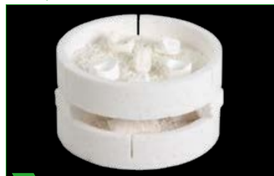
6 Sinterizzazione su due livelli di restauri Color/Multicolor.
