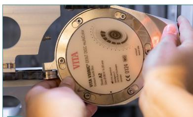
4 Fixer le VITA VIONIC DENT DISC multiColor dans le support de la fraiseuse. Fraisage l'arcade dentaire / les éléments dentaires.
