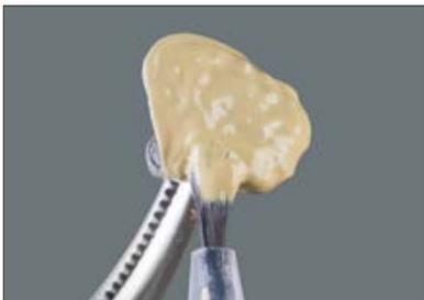
Es werden so viele dünne Schichten Pastenopaker aufgetragen (mind. 2), bis das Metall vollständig abgedeckt ist. Aufgrund seiner visko-elastischen Konsistenz hat OPAQUE PASTE eine hohe Standfestigkeit an Kanten und Retentionen. Zwischen den Polymerisationsschritten muss der OPAQUE PASTE auf der Anmischplatte vor Lichteinfluss geschützt werden.
