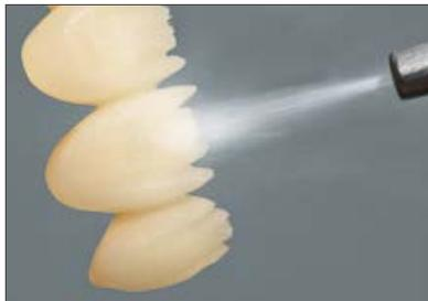
Um einen sicheren Verbund zwischen VITA CAD-Temp und VITA VM LC flow zu erzielen, wird die Oberfläche mit Aluminiumoxid (Korngröße 50 µm) bei einem Druck von 2 bar abgestrahlt.
