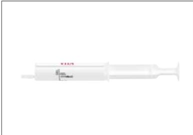
Zur Vermeidung der Inhibitionsschicht und somit zum leichteren Ausarbeiten empfehlen wir die Verwendung von VITA VM LC GEL bei der Endpolymerisation. Das Gel in einer deckenden Schicht direkt aus der Spritze oder mit einem Instrument (nicht mit einem Pinsel) auf die gesamte Verblendoberfläche auftragen.
