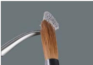
Nach dem Abstrahlen wird das Metallgerüst gereinigt. Die Reinigung erfolgt ausschließlich mit abgeschiedener Druckluft (Wasserabscheider) oder mittels sauberem Pinsel.
