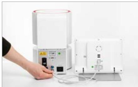
**1** Verbinden Sie Brenneinheit und Bedienelement mit dem Verbindungskabel.
