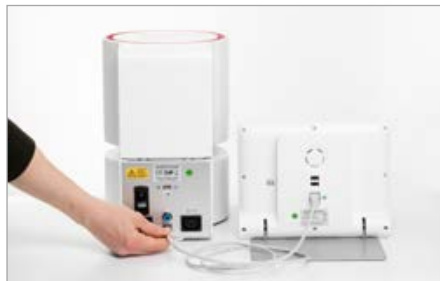
1 Raccordez le four et l'unité de commande à l'aide du câble de liaison.
