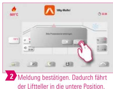
**2** Meldung bestätigen. Dadurch fährt der Liftteller in die untere Position.
