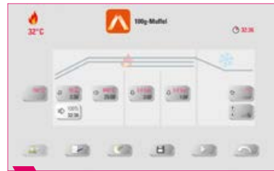
3 Toque brevemente el programa de cocción para acceder a la ventana de cocción.
