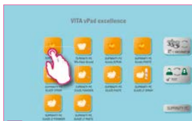
1 Appuyer de façon prolongée sur le bouton jusqu'à ce que le menu d'édition des boutons soit activé.
