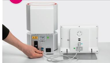
**Collegare unità di cottura e unità di comando con il relativo cavo.**
