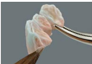
Depois de levantar a ponte do molde é necessário complementar os pontos de contato com DENTINE e ENAMEL.
