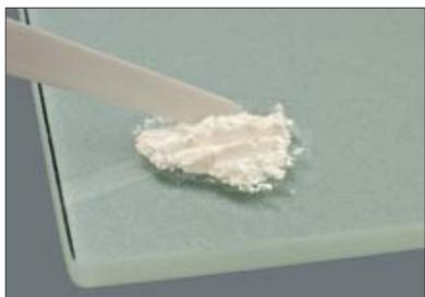
Devido à plastificação não é necessário qualquer líquido especial para a mistura. A massa é misturada com o VITA MODELLING LIQUID. Para obter uma relação de mistura homogênea, recomenda-se nas massas MARGIN misturar primeiro os pós (consulte "Tabelas de correspondência").
