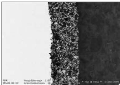
**Fig.:** Imagem MEV da estrutura muito homogênea do opaco da VITA VMK Master
