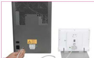
**1** Verbinden Sie Sintereinheit und Bedienelement mit dem Verbindungskabel.
