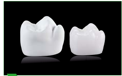
3 Γομφίος πριν και μετά την πυροσυσσώματωση. Συρρίκνωση πυροσυσσώματωσης περίπου 20 τοις εκατό
