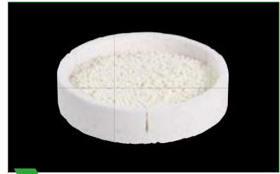
3 Πληρώστε το κύπελλο πυροσσωμάτωσης MS με σφαιρίδια πυροσσωμάτωσης (τουλάχιστον τριπλό στρώμα σφαιριδίων).
