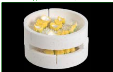
7 Sovrapposizione della base di sinterizzazione MS in caso di restauri cromatizzati manualmente.
