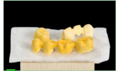
6 Essiccare tassativamente i restauri prima della sinterizzazione.
