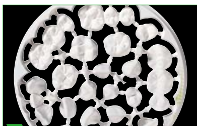
1 Restauro fresato con collegamenti.
