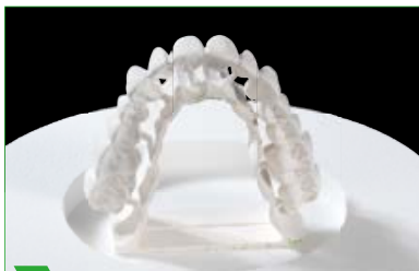
5 Restauri separati e rifiniti con supporto di sinterizzazione.
