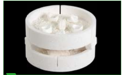
6 Двухэтажная синтеризация Color/Multicolor-реставраций.
