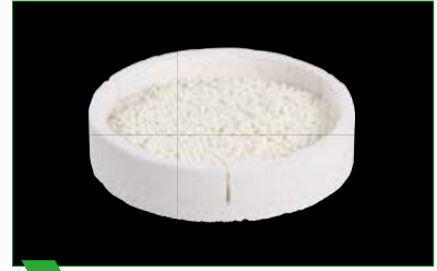
3 Заполнить синтеризационную чашку MS синтеризационными шариками (мин. 3 слоя циркониевых шариков).
