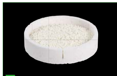
3 MS égetőcsésze szinter gyöngyökkel töltve (min. 3-rétegű gyöngyalap).
