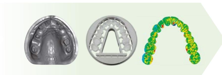
Abbildung 14a/b/c: a) Modell; b) gefräste, vielgliedrige VITA YZ-Konstruktion; c) Wrap-Software mit überlagerten Konstruktionen (v. l. n. r.)
