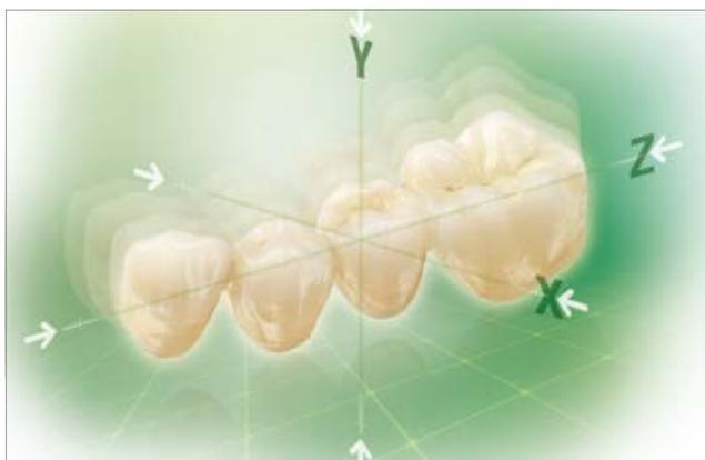
Figura 4: Esempio di retrazione di sinterizzazione (dimensione X, Y, Z)
