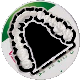
1 Brücke mit skelettiertem Sintersupport nach dem Fräsprozess.
