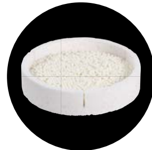
3 Sinterschale MS mit Sinterperlen (mind. 3-lagiges Perlenbett) füllen.
