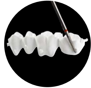
3 Desbastado de los conectores con fresa de diamante o de carburo de tungsteno.
