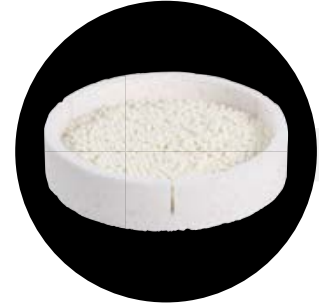
3 Llenar la bandeja de sinterización MS con perlas de sinterización (lecho de perlas de tres capas como mínimo).
