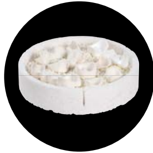
5 Bandeja de sinterización MS llena de restauraciones.
