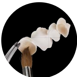
4 Pour éviter les problèmes d'ajustage, enlever toute trace de glaçure dans l'intrados.
