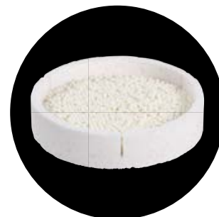
3 Remplir le réceptacle de frittage MS avec des billes de frittage (au moins triple couche de billes).
