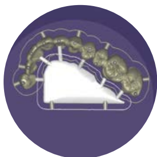
Lingua di sinterizzazione e drop di sinterizzazione.
