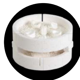
6 Sinterizzazione su due livelli di restauri.
