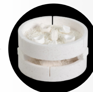
6 Frittage de restaurations par empilement.
