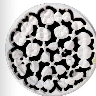
1 Restaurations fraisées avec connecteurs.
