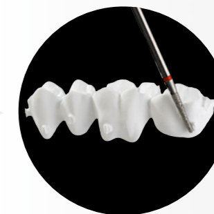
3 Meuler les connecteurs avec des diamants ou une fraise en carbure de tungstène.
