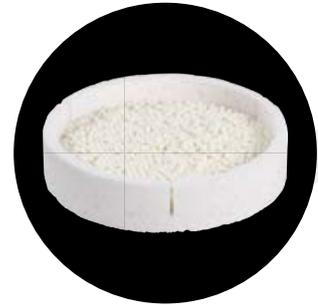
3 Sinterschale MS mit Sinterperlen (mind. 3-lagiges Perlenbett) füllen.
