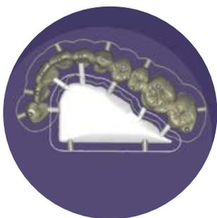
Sinterzunge und Sinterdrops.
