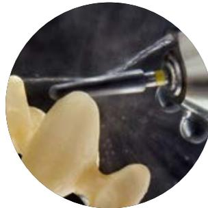
2 Bearbeitung mit Turbine unter Wasserkühlung.
