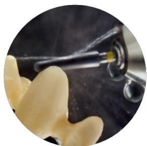
2 Usinage avec turbine sous refroidissement à eau.
