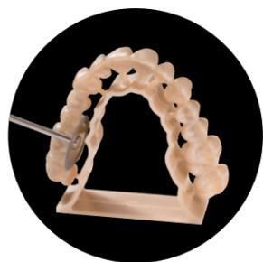
1 Separare con cautela la struttura per ponte.
