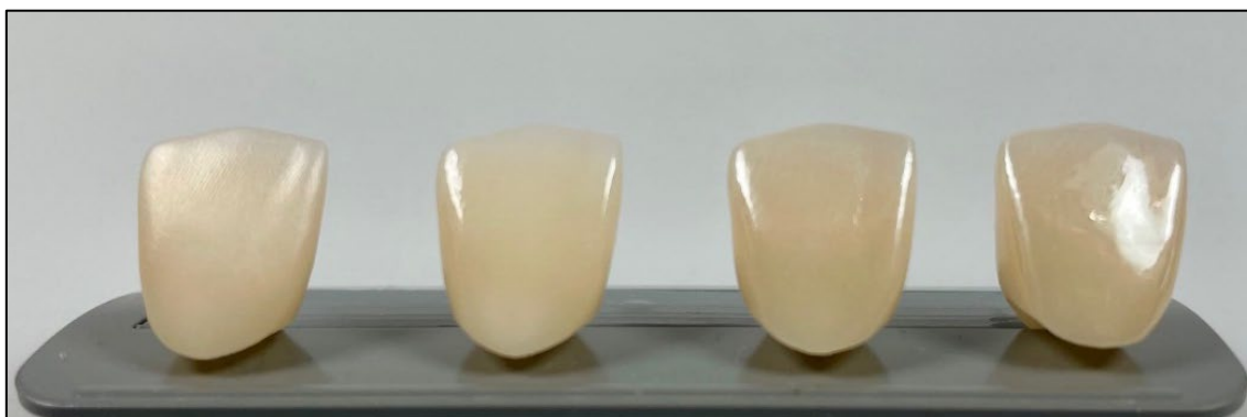
Figura 10: Da sinistra a destra: solo lavorato con CAM, glasato, spazzolato con pasta lucidante e lucidato
