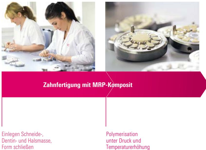
Abbildung 10 a: Schematische Darstellung der Herstellungsverfahren von Prothesenzähnen aus MRP-Komposit; Quelle VITA F&E
