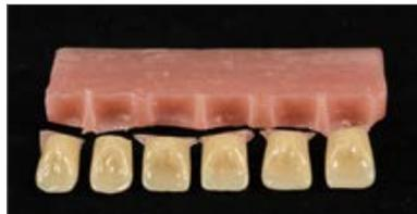
**Abbildung 14 d:** Bruchbild; Zahnbasis wurde lediglich mit Haftvermittler benetzt
