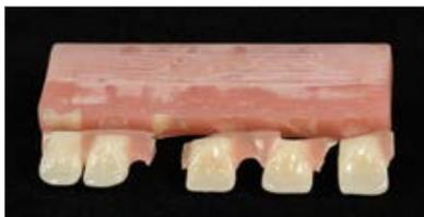
**Abbildung 14 a:** Bruchbild; Zahnbasis wurde sandgestrahlt und mit Haftvermittler benetzt
