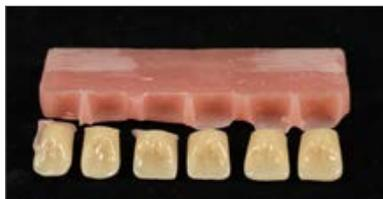
**Abbildung 14 b:** Bruchbild; es erfolgte keine Oberflächenvorbehandlung der Zahnbasis
