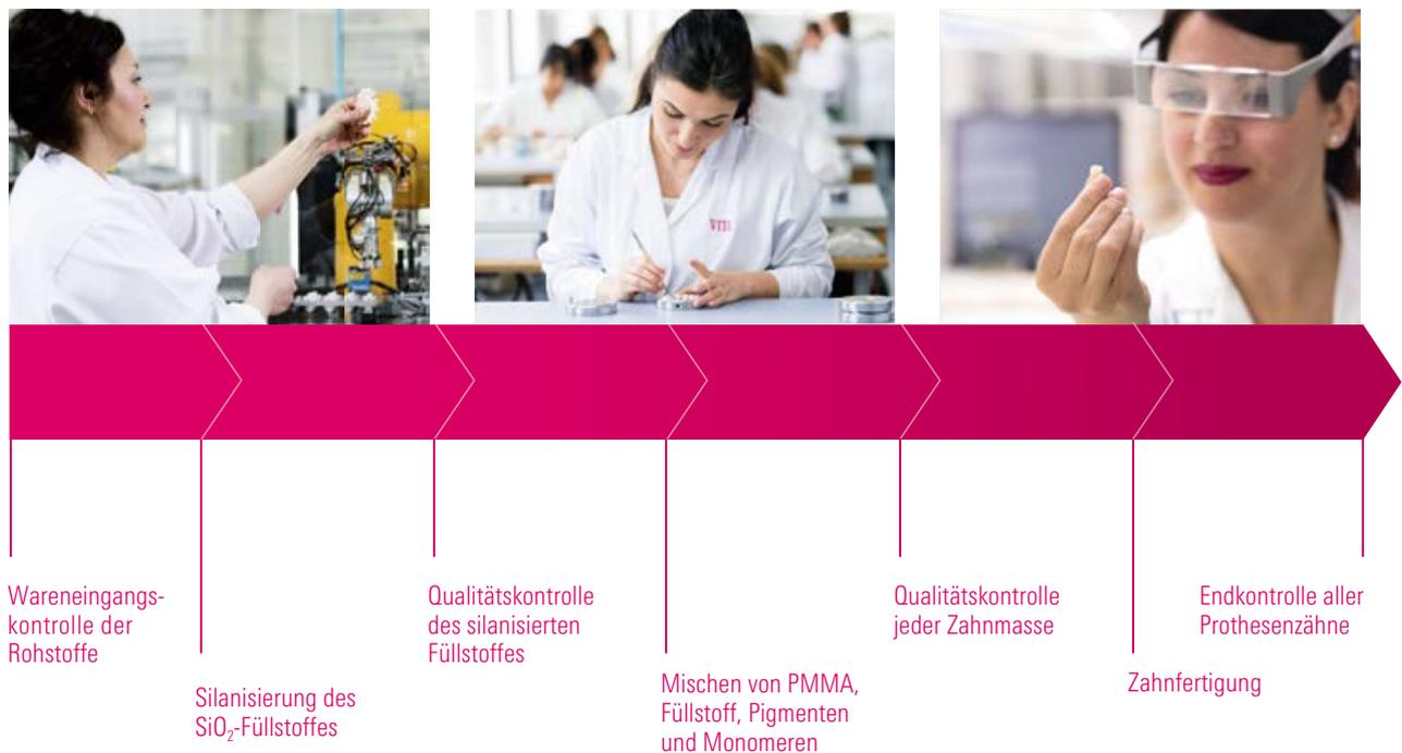
Abbildung 8: Prozess zur Herstellung von VITA Prothesenzähnen; Quelle VITA F&E
