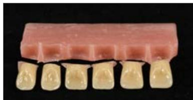
**Illustration 14 d** : schéma de rupture ; seul un adhésif a été appliqué sur la base de la dent
