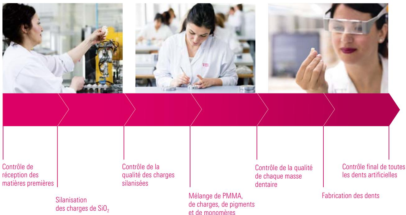
**Illustration 8** : processus de fabrication des dents artificielles VITA ; source : R&D VITA
