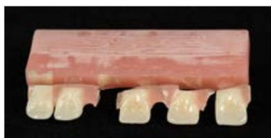
**Illustration 14 a** : schéma de rupture ; la base de la dent a été sablée et un adhésif a été appliqué
