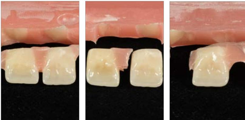
**Illustration 13 a – c** : schéma de rupture caractéristique au test de liaison de VITA PHYSIODENS avec les matériaux de base susmentionnés (matériaux de base de la gauche vers la droite : FuturaGen, ProBase Cold, PalaXpress)
