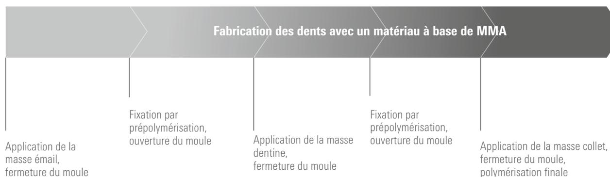
**Illustration 11** : représentation schématique du procédé de fabrication des dents artificielles en (P)MMA ; source : R&D VITA
