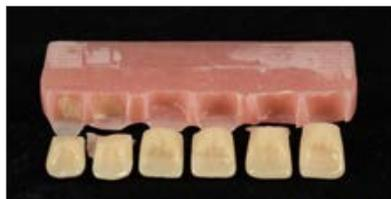
**Illustration 14 c** : schéma de rupture ; prétraitement de la base de la dent uniquement par sablage
